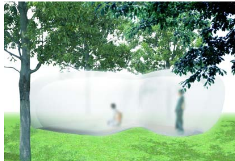
Nach Gebrauch verschwinden die aufblasbare Membran und der zum Teil mit Tatamimatten ausgelegte Boden unter Stahlpaneelen, die das Teehaus vor Wind, Wetter und Vandalen schützen.
